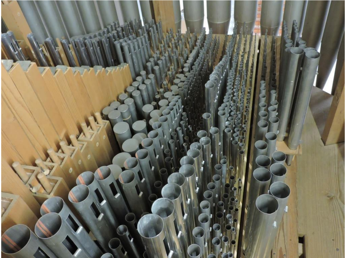
Abb. 14: Die rekonstruierte Mixtur 5\frac{1}{3}' auf dem 3. Stock (von rechts); auf dem 4. Stock steht der originale Cornett 8' (Bernhard Hörler).
